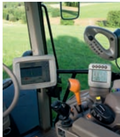
Der Bordcomputer registriert über GPS die Position auf dem Feld und steuert passend die Düngerabgabe.
