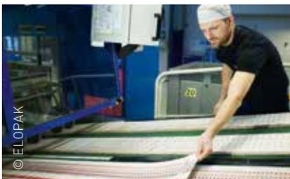
Eine weitere Maschine schneidet aus der Rolle Rechtecke für die einzelnen Packungen. Bei Bedarf stanzt sie auch Löcher für den Ausguss rein. Sie knickt die Kartons an ihren Kanten und verschweißt sie an den Seiten.
